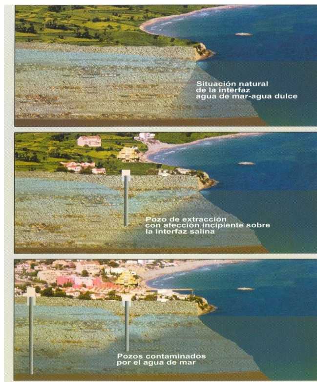
Figura 37. Esquema de la intrusión de la cuña de agua salada
